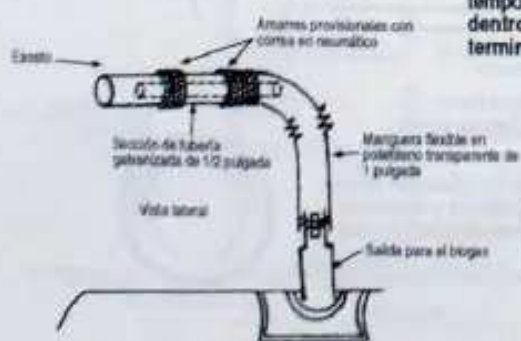
Conexiones para el llenado de la bolsa con humo y posterior salida del biogas
