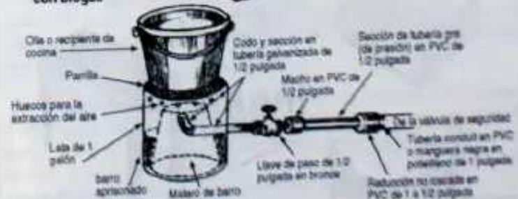
Quemador del fogón para cocción con biogas
